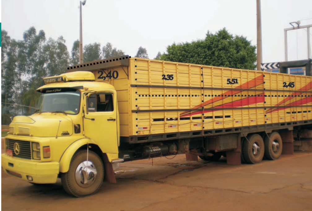
A capacidade de carga do caminhão truck acima é 18 animais de 500kg, sendo 4 no 1º compartimento, 10 no 2º e 4 no 3º
