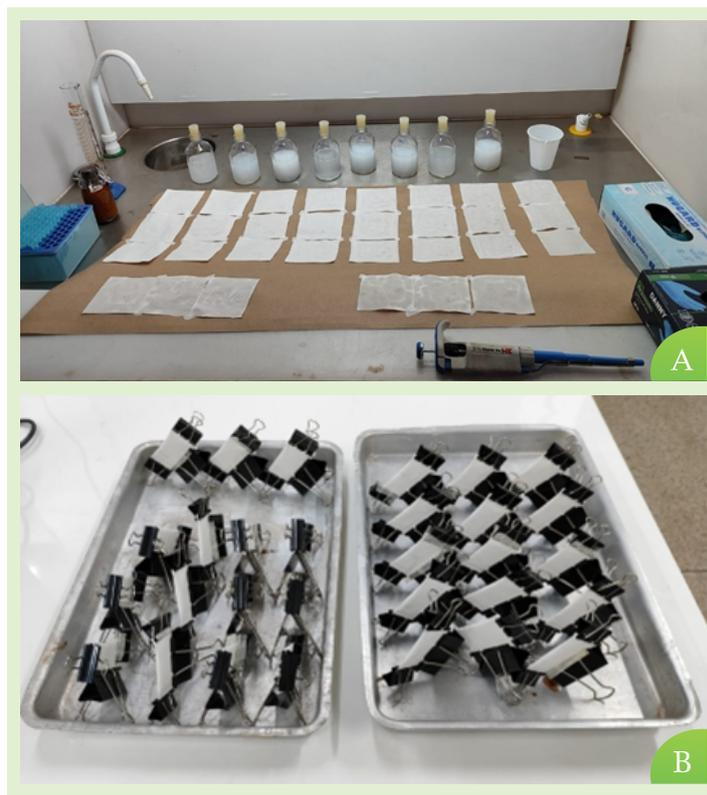
Figura 6. Testes de avaliação da resistência a acaricida. (A) Diluição acaricida e impregnação em papel filtro para o teste de pacote de larvas (TPL) e (B) pacotes impregnados com acaricidas para desafio de larvas de *Rhipicephalus microplus* usando o teste de pacote de larvas (TPL) (Fonte: Museu do carrapato/Embrapa Gado de Corte).
